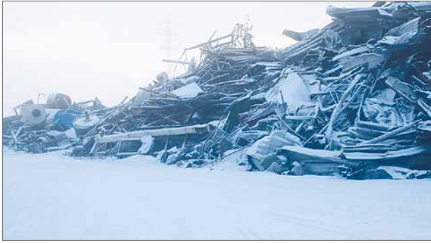
Kierrätettävän aineksen joukossa on raudan lisäksi, kuparia, ruostumatonta terästä, alumiinia, messinkiä jne. Lajittelu suoritetaan kokemukseen perustuen silmämääräisesti.
