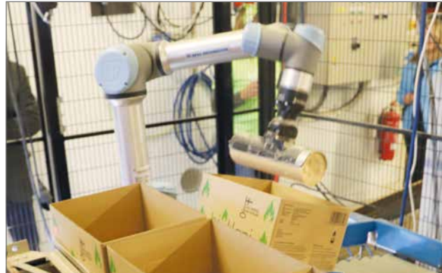
Brikettien pakkaamisen suunniteltu robotti tekee työtään automaattisesti ja väsymättä.
