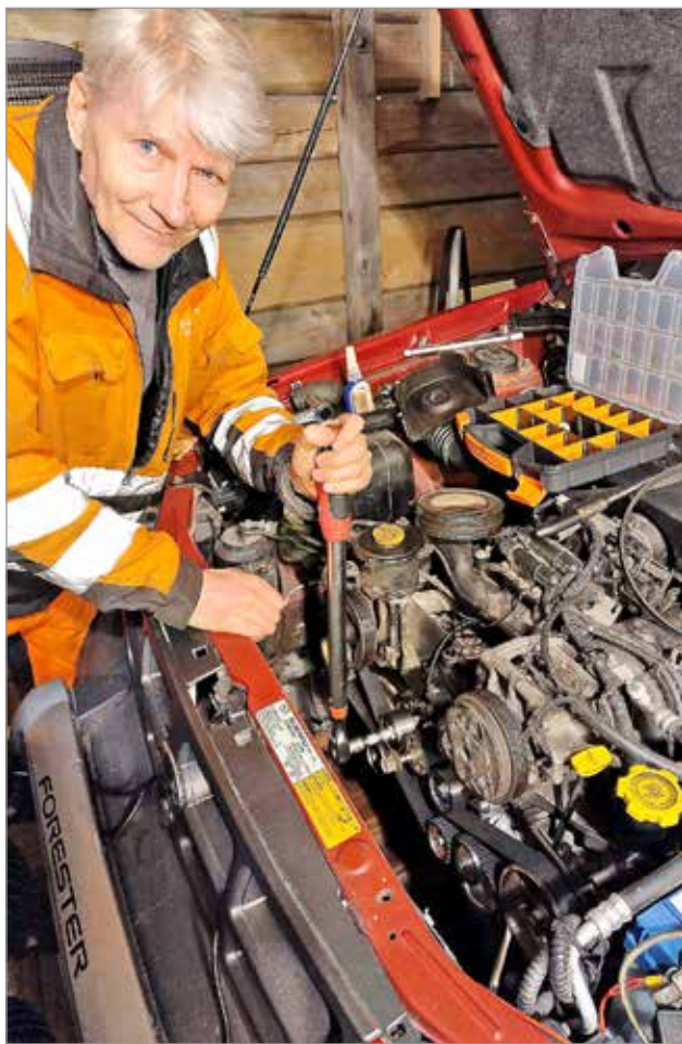
Tapio Vuorma Subaru jakohihnan vaihtotyössä Jakun Pajalla. (Kuva Seija Vuorma)
